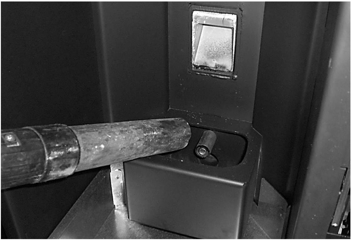
Aspirar, con un aspirador de cenizas, la ceniza que se deposita bajo el brasero.
