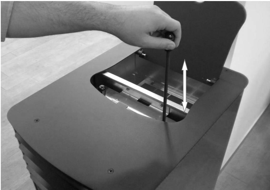
Después de abrir la puerta de carga de pellet tirar de los dos mandos para limpiar los conductos de humos posteriores.
