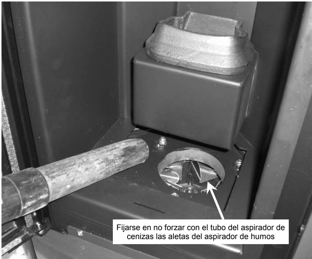
Aspirar el interior del depósito utilizando un aspirador de cenizas idóneo y después volver a colocar el fondo y el cenicero.
